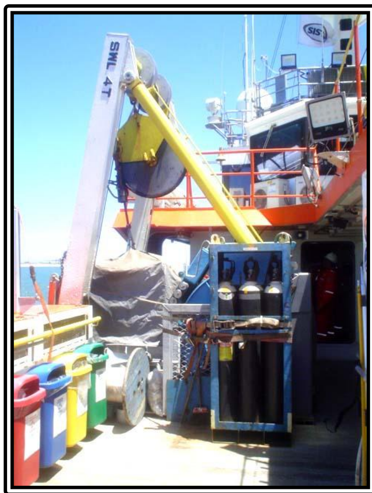
FOTO Nº 45:- CONVÉS SUPERIOR – MERGULHO - A-FRAME ROV “TIGER” – VEÍCULO SUBMERSÍVEL DE INSPEÇÃO OPERADO REMOTAMENTE BOMBORDO
