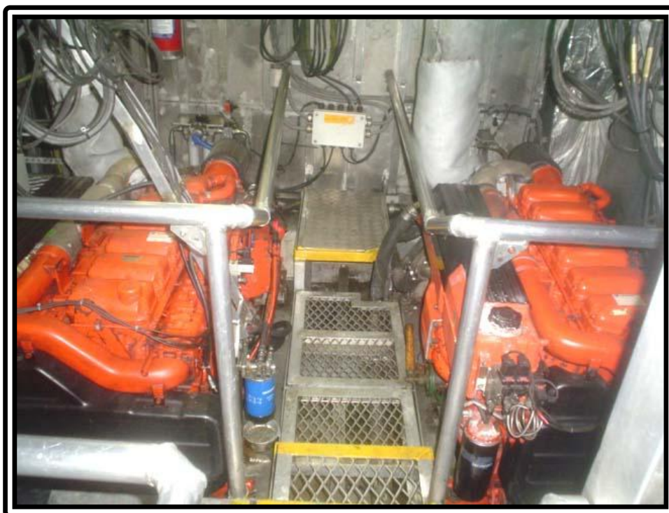
FOTO Nº 41:- PRAÇA DE MÁQUINAS – MOTORES DIESEL MARÍTIMO BOMBORDO “SCANIA” POT. 550HP
