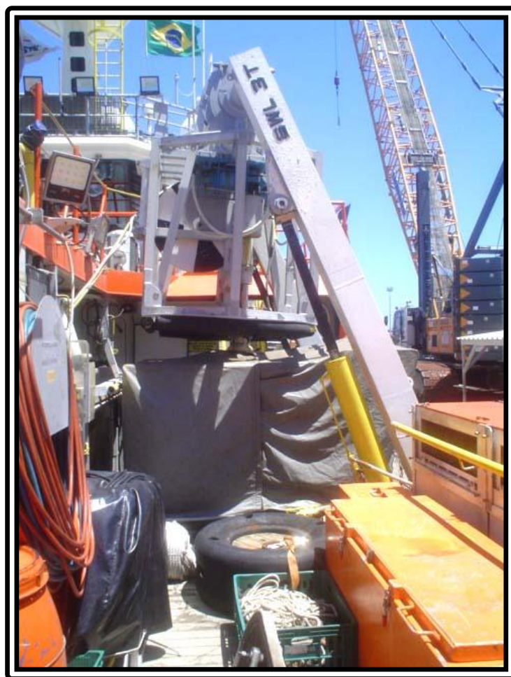
FOTO Nº 45:- CONVÉS SUPERIOR – MERGULHO - A-FRAME ROV “ATOM” – VEÍCULO SUBMERSÍVEL DE INSPEÇÃO OPERADO REMOTAMENTE BORESTE
