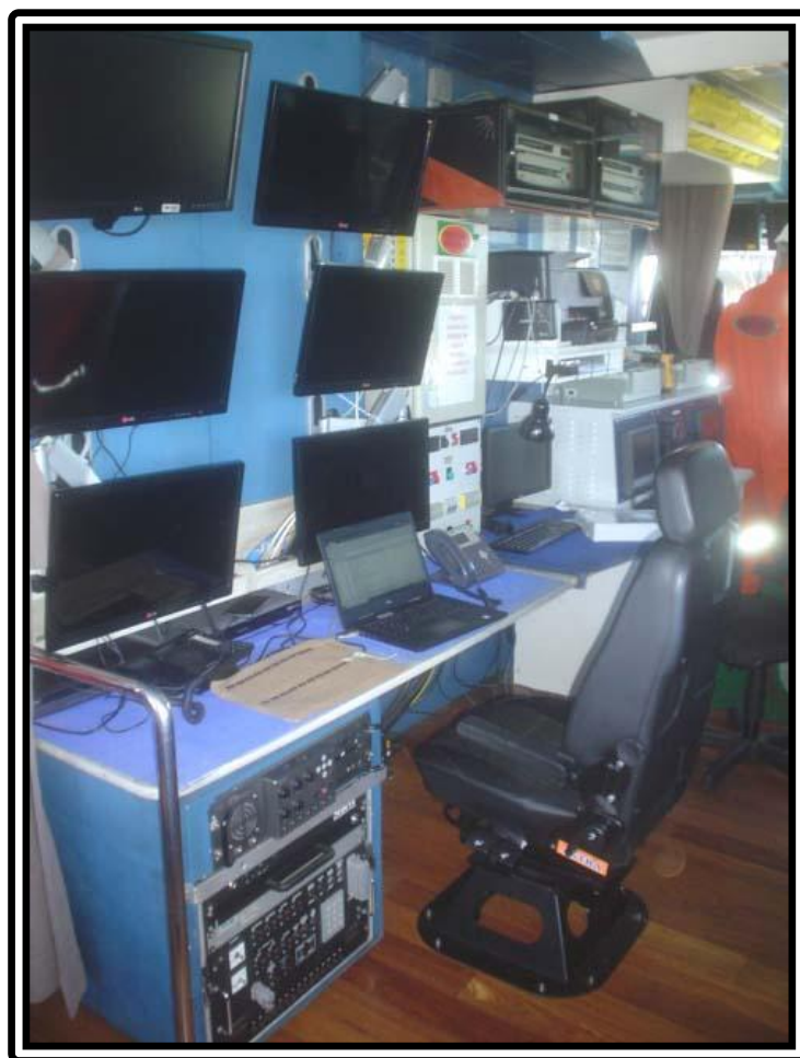
FOTO Nº 14:- PASSADIÇO – CENTRAL DE CONTROLE E MONITORAMENTO ROV “TIGER” - BOMBORDO
