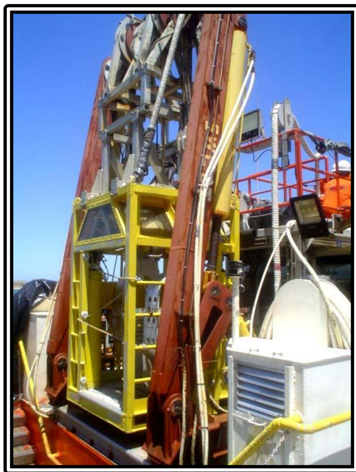
FOTO Nº 48:- CONVÉS SUPERIOR – CONJUNTO ESTRUTURAL A-FRAME PARA MERGULHO
