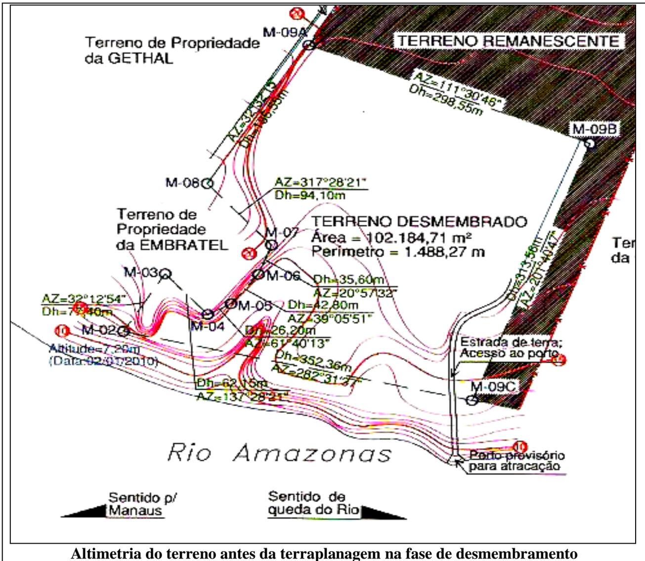
Altimetria do terreno antes da terraplanagem na fase de desmembramento
