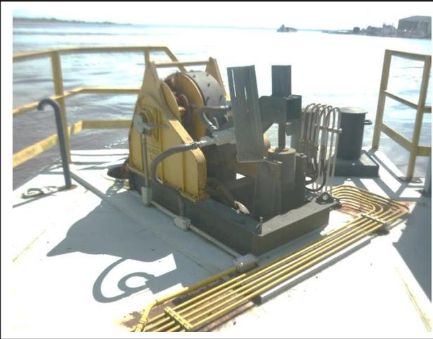
Sistema de ancoramento da embarcação
