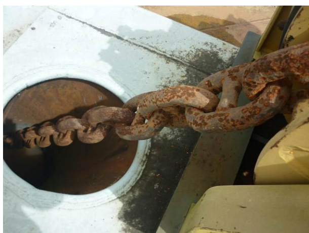
Sistema de ancoramento da embarcação
