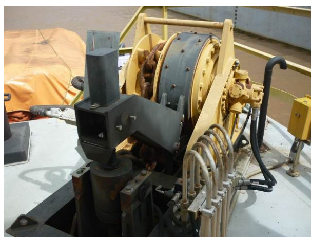
Sistema de ancoramento da embarcação
